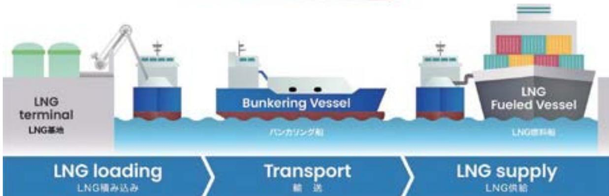
まず、大阪ガスの2つのLNG基地(泉北基地、姫路基地)からバンカリング船にローディングアームを用いてLNGの積み込みを行います。その後、LNGを主燃料とした船舶(LNG燃料船)の停泊地まで輸送します。LNG基地で積み込んだLNGは輸送時においてバンカリング船の燃料としても利用されます。停泊地到着後は、LNG燃料船とバンカリング船をフレキシブルホースを用いて接続し、LNGを供給します。
