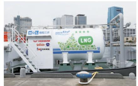
船尾に設置されたLNG燃料タンク
